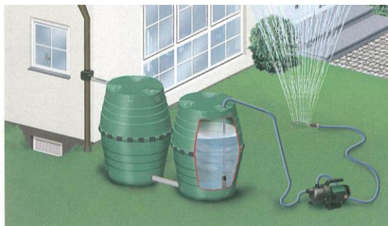
Fig. 5.13 – Mise en place du système Top Tank jumelé avec arrosage automatique
